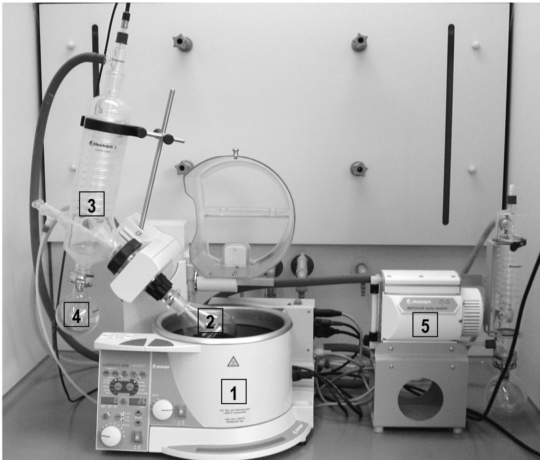
**Abbildung 4-3:** Aufbau des Rotationsverdampfers zur Kristallisation von Bernsteinsäure.
