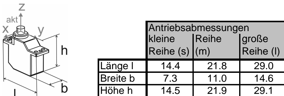
Abbildung 5.13: Der verwendete Motortyp zur Aktuierung der Bauelemente der mittleren Baugröße des Mechanismen-Baukastens sowie dessen Abmessungen. Zusätzlich sind durch Extrapolation ermittelte, ungefähre Abmessungen möglicher Antriebe der kleinen sowie der großen Baureihe angegeben.
