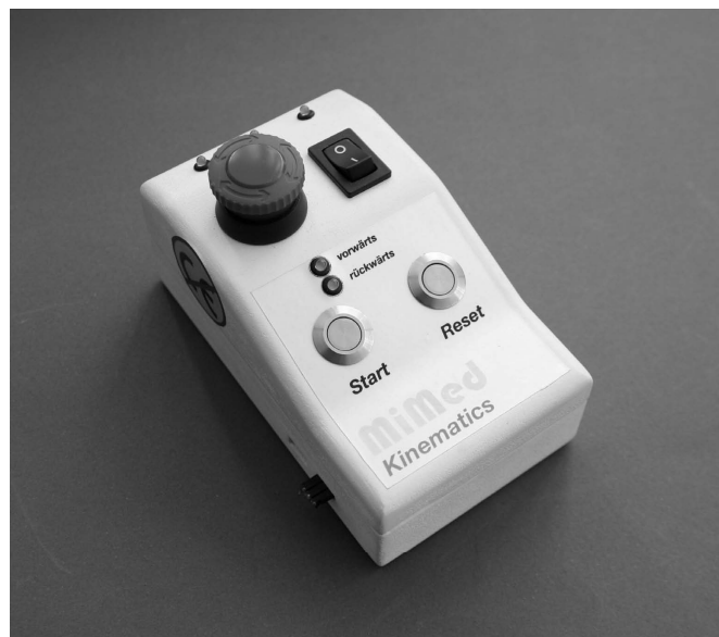
Abbildung 6.16: Steuerbox zur Bedienung der entwickelten Kinematiken: Der Funktionsumfang umfasst neben den Benutzerschnittstellen zum Start/Stopp der Bewegungsdurchführung zusätzliche Anzeigenmöglichkeiten zur Darstellung der Systemzustände.
