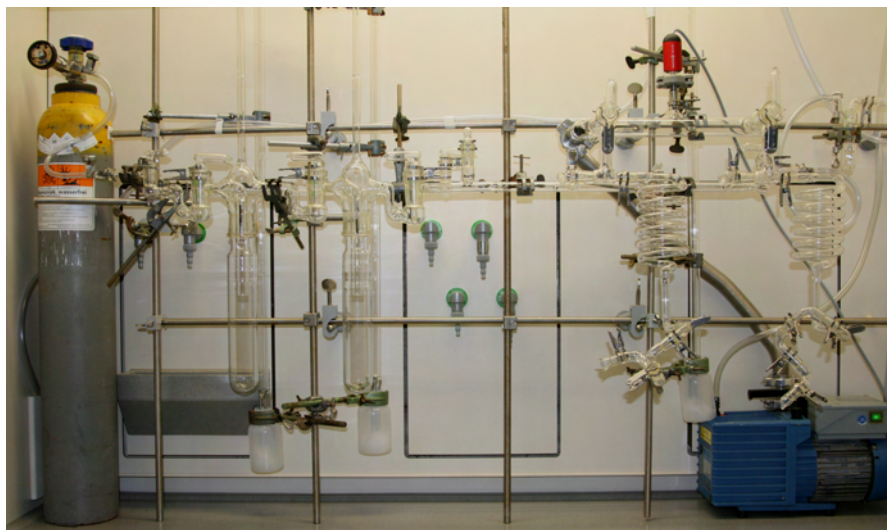
Abbildung 5.1. Schutzgasanlage zum Arbeiten mit flüssigem Ammoniak.
