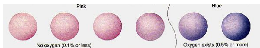
Bild 2-4: Farbumschlag des O 2 -Indikators Ageless-Eye in Abhängigkeit von der O 2 -Konzentration [20]
