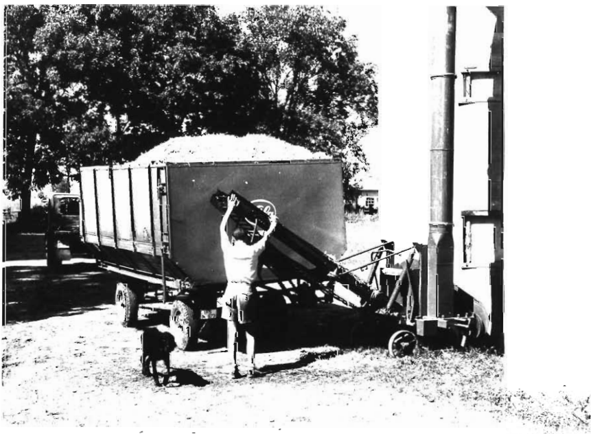
Annahmegebläse Nr. 3 mit klappbarem Annahmetrog. Gleichgut geeignet zum Fördern von Silier- und Trockengut.
