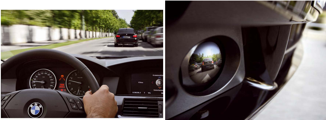
Abbildung 6.29: Anzeigen des BMW ACC Stop&Go Systems im BMW 5er und Radarsensor unter dem Stoßfänger
