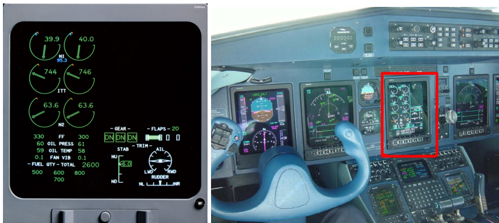
Abbildung 3.8: Rockwell Collins EICAS-5000 (Engine Indication and Crew Alerting System, Rockwell Collins, 2008) im Detail und EICAS System in einer Dornier 328-110
