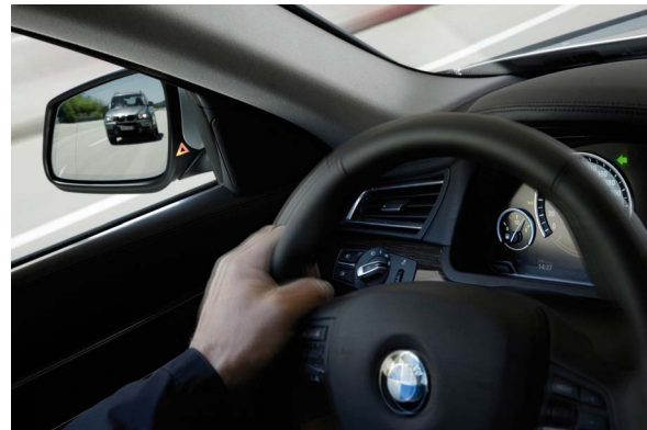
(b) Spurwechselwarnung im BMW 7er: LED im Spiegelfuß und Lenkradvibration (BMW Pressclub, 2008)
