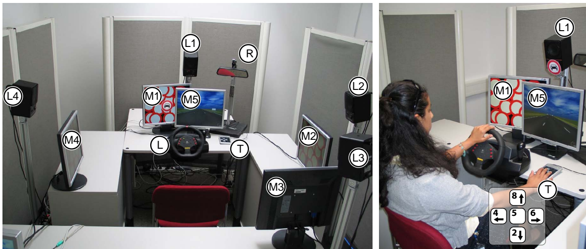
Abbildung 5.2: Laborexperiment mit vier Lautsprechern (L1-4), den dazugehörigen Monitoren (M1-4), Rückspiegel (R), Monitor für Lane-Change-Task (M5), Lenkrad zur Steuerung des Lane-Change-Task (L) und Nummern-Tastatur zur Auswahl der Richtung (T)
