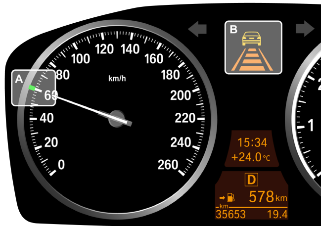
Abbildung 6.30: Scheibenzeiger (A) zur Markierung der aktuellen Wunschgeschwindigkeit und ACC Symbolik (B) zur Darstellung des Wunschabstands und zur Indikation eines erkannten Vorderfahrzeugs
