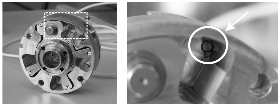
Bild 2.9: Stirnseitig applizierter Drucksensor im Stator des Nockenwellenverstellers
