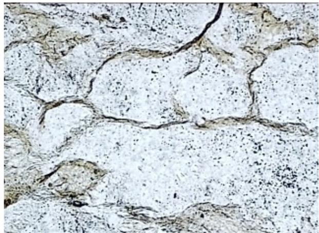
**Abbildung A1 - 28: BB = 0,5 mm, lin-pol; Detail aus Abbildung A1 - 27, mit dem deutlich erkennbaren Glimmernetzwerk**
