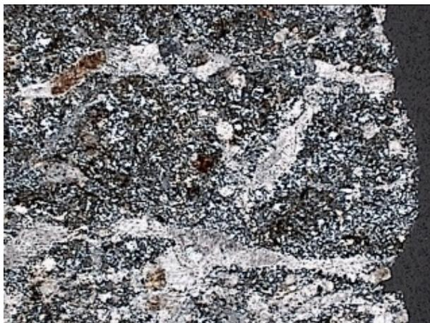
Abbildung A1 - 22: BB = 2,1 mm, X-pol; Flint mit Carbonatdurchhäderung
