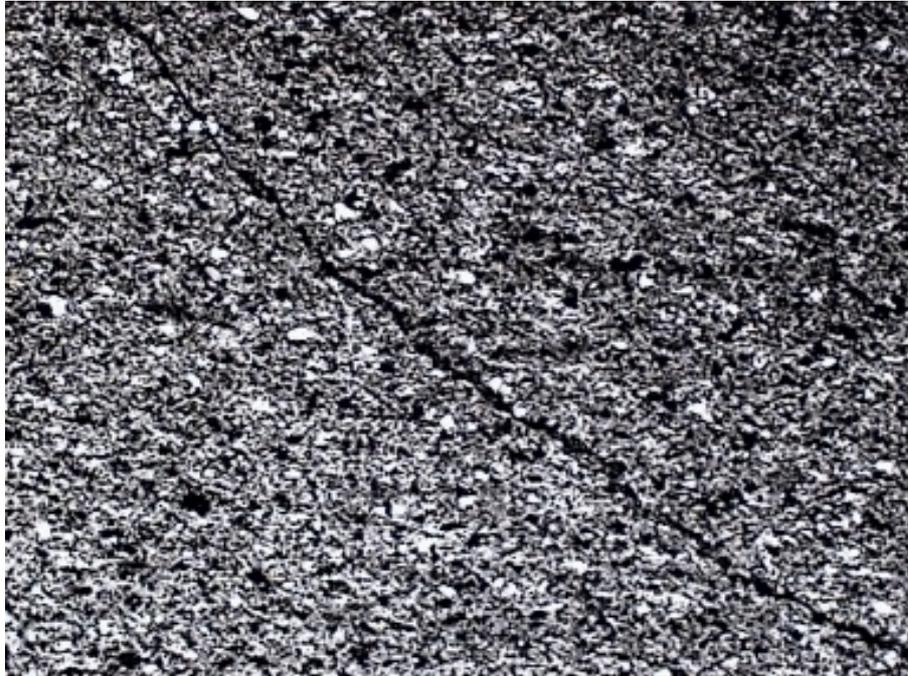
**Abbildung A1 - 8:BB = 2,1 mm, lin-pol; leicht geschiefertes toniges Gefüge mit Zerrkluft diagonal zur Schieferung**
