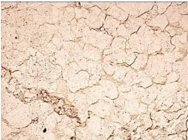
**Abbildung A1 - 27: BB = 2,1 mm, lin-pol; Quarzit mit durchgreifendem Netzwerk einer Glimmertapete im Intergranularraum**
