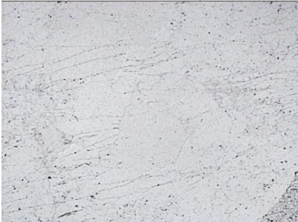
**Abbildung A1 - 25: BB = 2,1 mm, lin-pol; Quarzit mit verheilten Spuren spröder Deformation**
