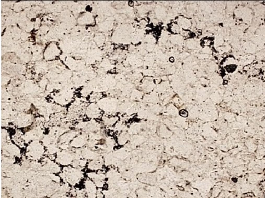
**Abbildung A1 - 24: BB = 2,1 mm, lin-pol; 3-dimensional vernetzter Porenraum**
