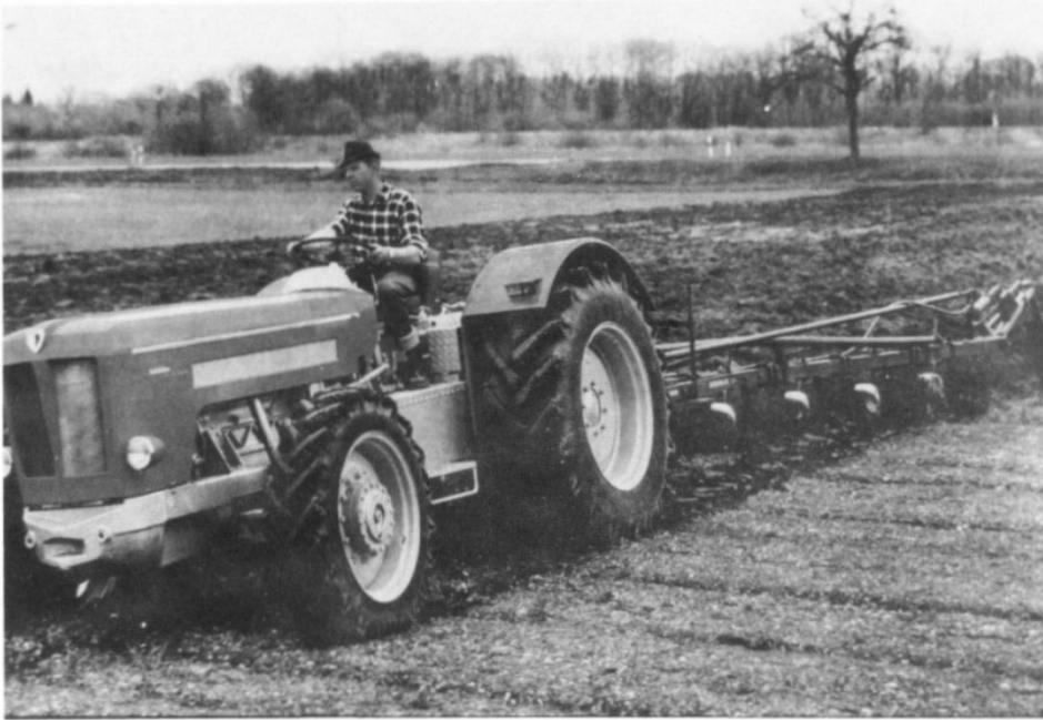
Abb. 3: Der große, 150 PS-starke Schlüter-Schlepper Super 1500 V, aus der Typenreihe des Jahres 1966, ausgestattet mit Allradantrieb
