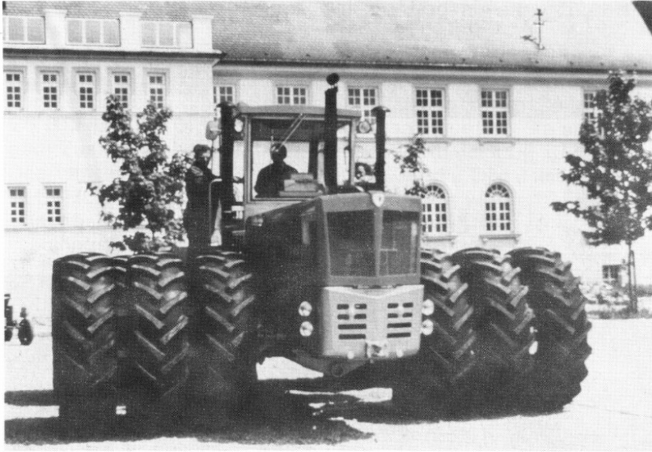
Abb. 4a: Schlüter Profi Trac 5000 TVL - 500 PS - 368 kW. Großvolumiger 12-Zylinder-Turbo-Dieselmotor, wassergekühlt. Hubvolumen 21 l
