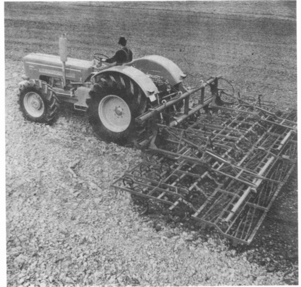
Abb. 3a: Ein weiterer Schlepper dieser Baureihe: Schlüter Super 1500 V - 150 PS - bei der Oberflächenbodenbearbeitung. 8-Zylinder-Motor, Hubraum 9,5 l
