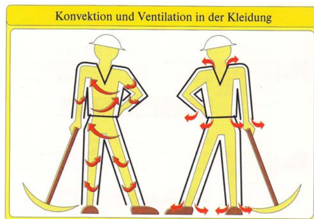
Bild 67: Konvektion und Ventilation in der Kleidung (MECHEELS 1998)
