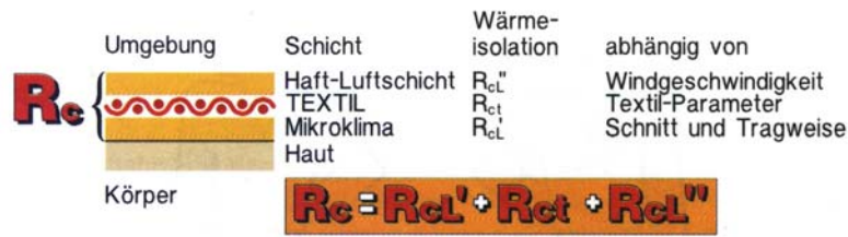
Bild 62: Textil- und Luftschichten; Wärmeisolation (MECHEELS 1998)
