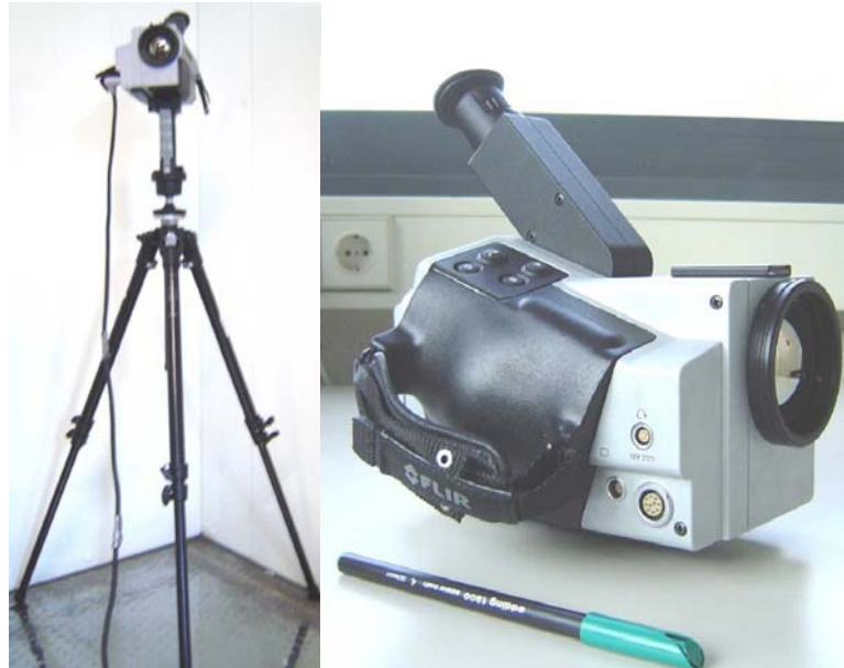
Bild 84: IR-Kamera mit Stativ in der Klimakammer (li); IR-Kamera der Firma FLIR® Systems GmbH (re)
