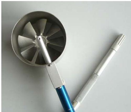
Bild 82: Flügelradanemometer und Temperatur-/Feuchtesensor der Firma Schiltknecht
