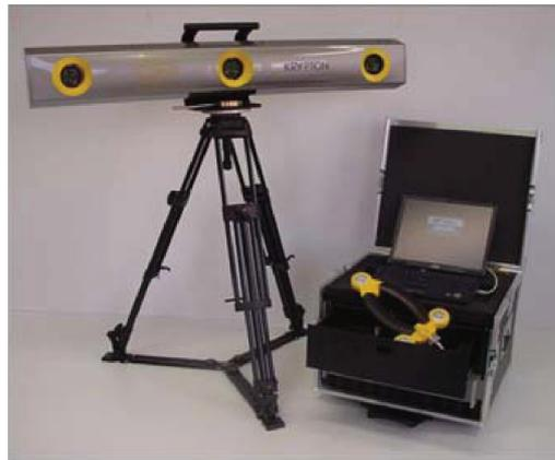
Abbildung 3.2: Infrarot-Kamera der Firma Metris
