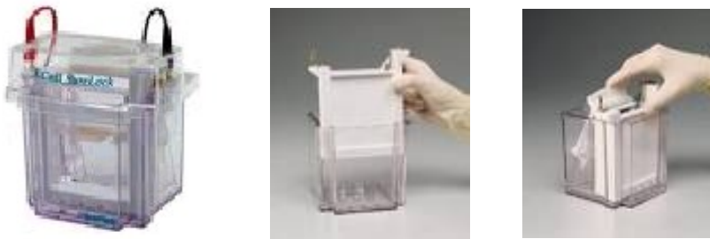
Abbildung 7: Dargestellt ist die Novex-Mini-Zellkammer sowie die Bestückung mit dem Polyacrylamid-Gel. Quelle: Invitrogen. URL: http://www.invitrogen.com/content.cfm (07.06.07)
