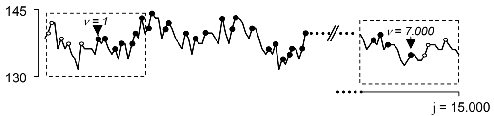
Abbildung 3: Definition der Ankerpunkte. Alle Ankerpunkte (schwarze Punkte) werden mit dem Index v nummeriert. In diesem Signal lassen sich 7.000 Ankerpunkte bei 15.000 Herzfrequenzwerten berechnen.
