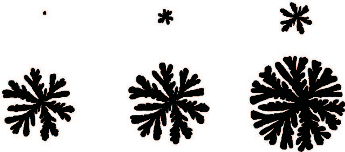
Abbildung 6.22: Verschiedene Stadien der Entwicklung einer Kavität mit ausgeprägten Saffman-Taylor Instabilitäten. Die Bilder entsprechen der von der Software erkannten Kavitätsfläche. Die laterale Ausdehnung (Ferret-Durchmesser) der Kavität ist in den abgebildeten Momentaufnahmen 0.09, 0.29, 0.59, 1.24, 1.38 und 1.60 mm.
