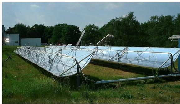
Abb. 3.7 Horizontal aufgestellte IST-Parabolrinnen-Kollektoren auf dem Testgelände der DLR in Köln
