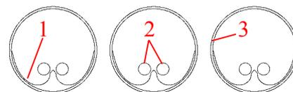
Abb. 3.2 Querschnitt durch einen CPC-Kollektor mit u-förmigem Absorber; 1: CPC-Reflektor, 2: Absorber, 3: transparente Hülle; Details siehe Abb. 3.6
