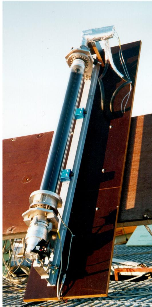
Abb. 7.7 Evakuierter Röhrenkollektor mit intern nachgeführtem Reflektor einmal aus einer Richtung außerhalb des Akzeptanzbereiches betrachtet (links). Man erkennt, dass der Reflektor die helle Umgebung reflektiert. Rechts sieht man den den Absorber abbildenden Reflektor aus einer Richtung innerhalb des Akzeptanzbereiches.
