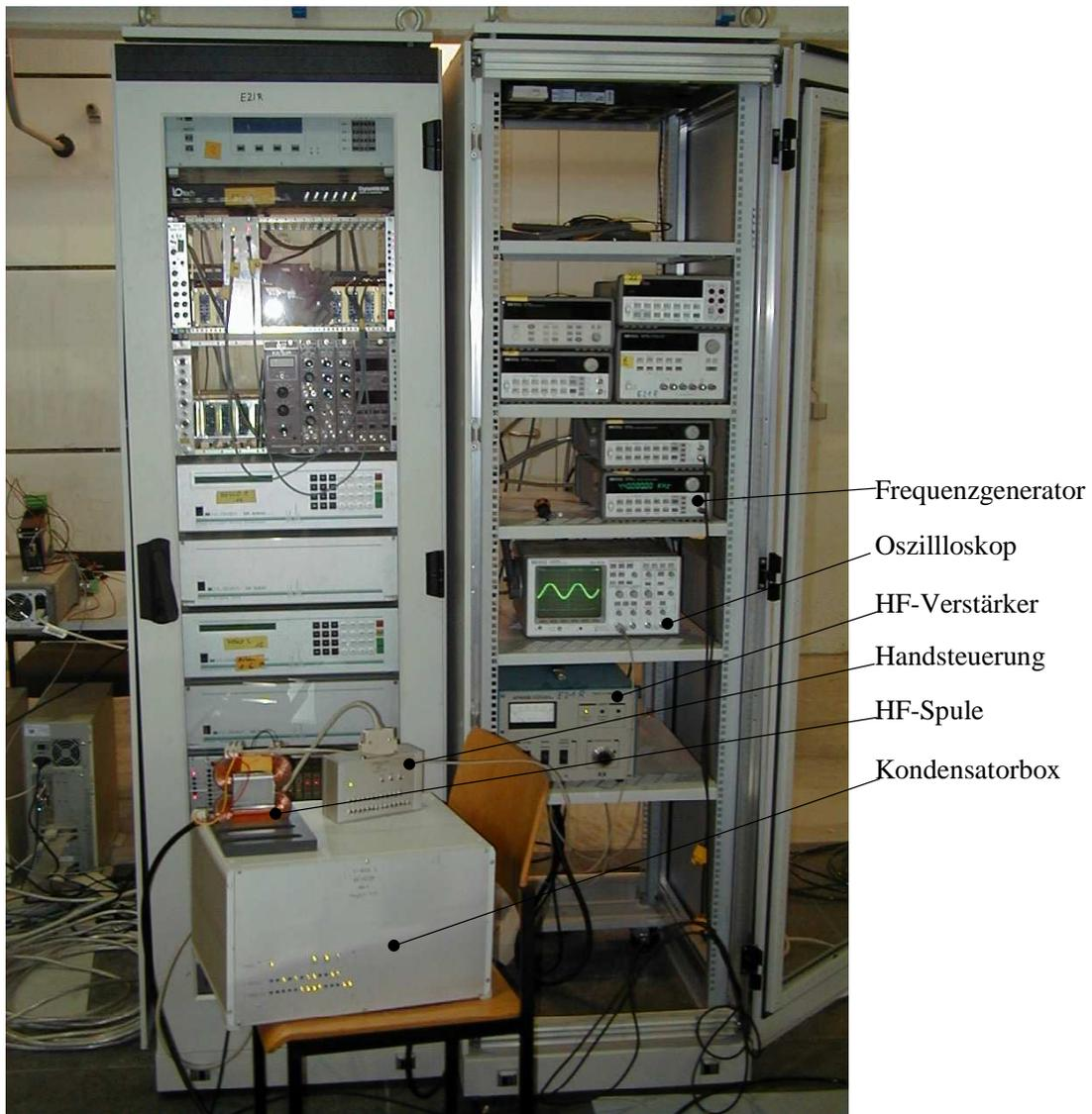
Abbildung 4-4: Versuchsaufbau: Mit dem Frequenzgenerator und dem HF-Verstärker kann man die Frequenz durchstimmen, mit der Handsteuerung an der Kondensatorbox stellt man die Resonanzfrequenz ein, das Oszilloskop zeigt die Spannung an der Pickupspule an. Diese ist auf die Spule im Schwingkreis aufgewickelt und an ihr gemessene Spannung ist proportional zu dem Strom im Schwingkreis.
