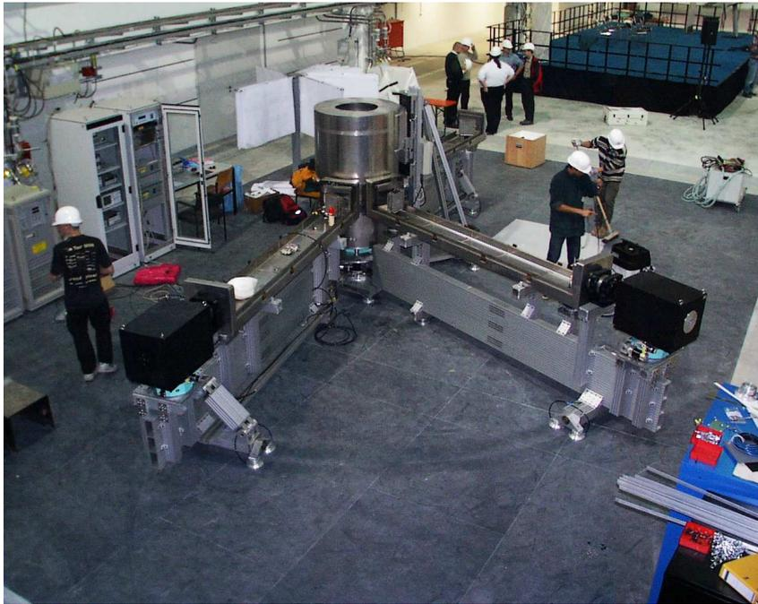
Abbildung 3-14: Foto der Spektrometers, die schwenkbaren Sekundärarme sind gut zu erkennen.
