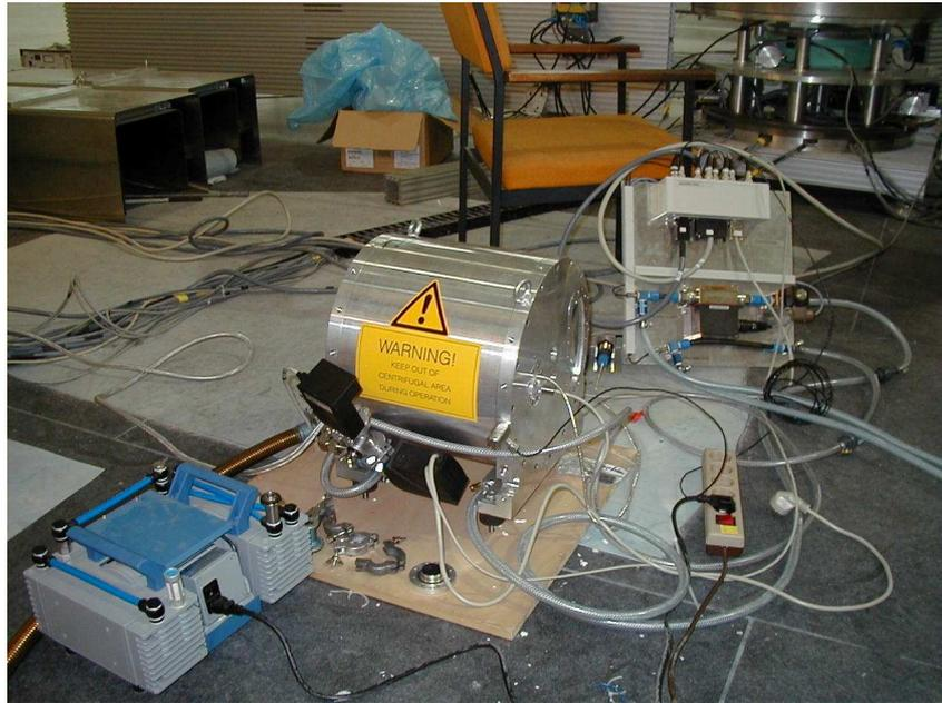
Abbildung 3-13: Foto des Neutronenselektors mit dem Aluminiumfenster für die Neutronen auf der Stirnseite
