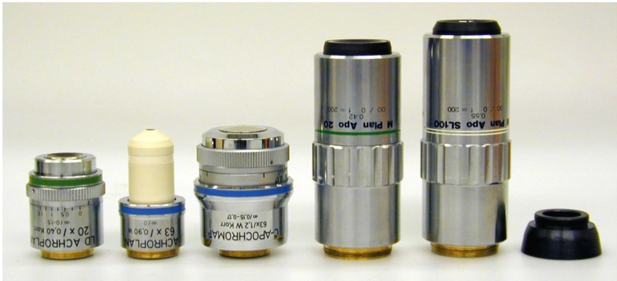
**Abbildung 4.8:** Objektive zur Beobachtung und Messung. (von links) Zeiss x20/0,40; Zeiss x63/0,9W; Zeiss x63/1,2W; Mitutoyo x20/0,42L; Mitutoyo x100/0,55L. (rechts) Gewindeadapter um Mitutoyo-Objektive an Standard-Mikroskopgewinde anzubringen.
