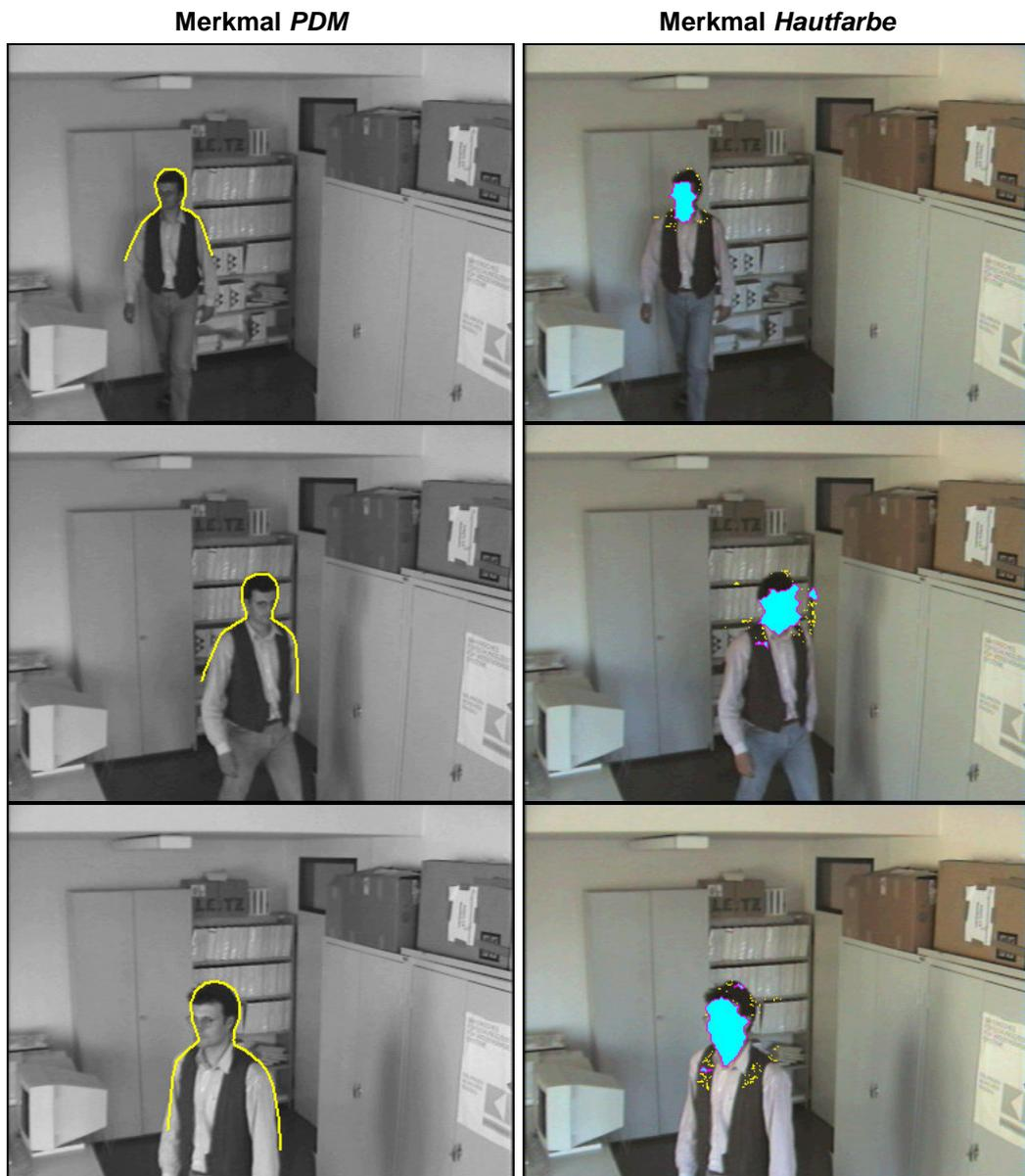
Bild 5.4: **Monokulare Detektion.** Links: Detektion mit flexiblem Konturmodell (PDM). Rechts: Detektion mit Merkmal "Hautfarbe" (skin). Die gefundene Silhouette bzw. der Bereich, der durch Farbklassifikation als ‚hautfarben‘ klassifiziert wurde, sind farbig markiert.
