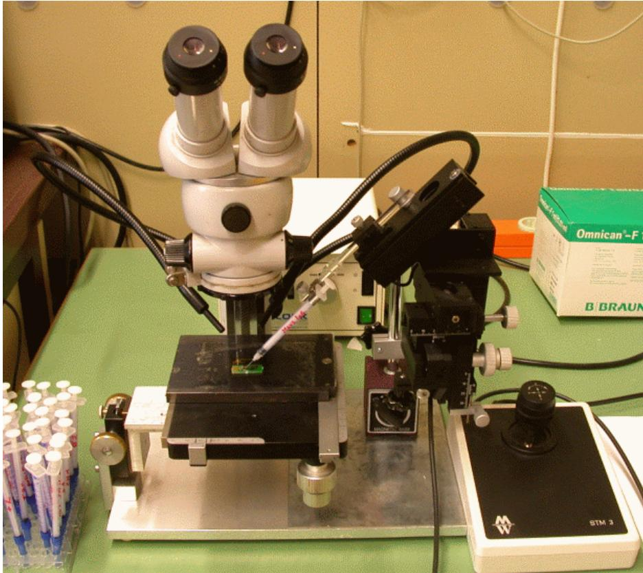
**Abbildung 16:** Versuchsaufbau zur selektiven Beschichtung der Sensorchips, bestehend aus Mikroskop, Mikromanipulator und Spritze.
