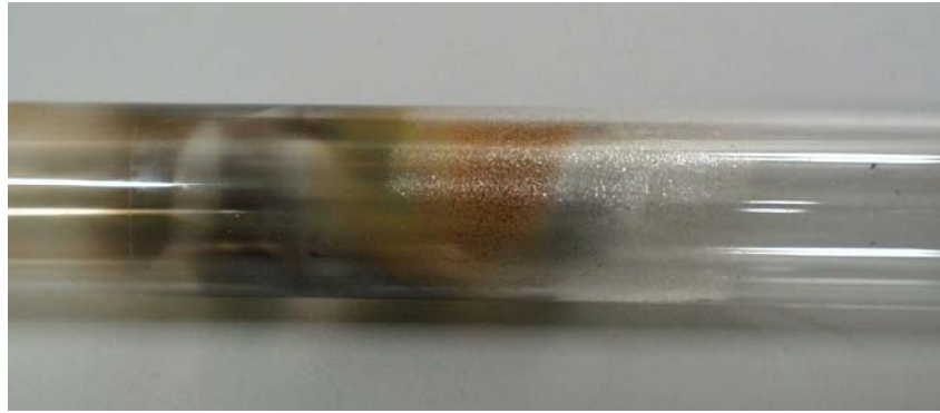
Abbildung 105: Quarzrohr nach einem Vergasungsversuch bei 900°C in N 2 -Atmosphäre ohne Sauerstoff
