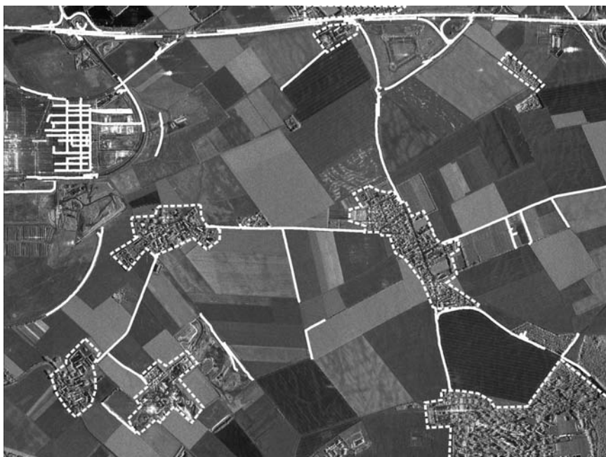
Abbildung 4.23. Datensatz Stadtrand-1m : Extraktionsergebnis mit 10 und 16 m Linienbreite
