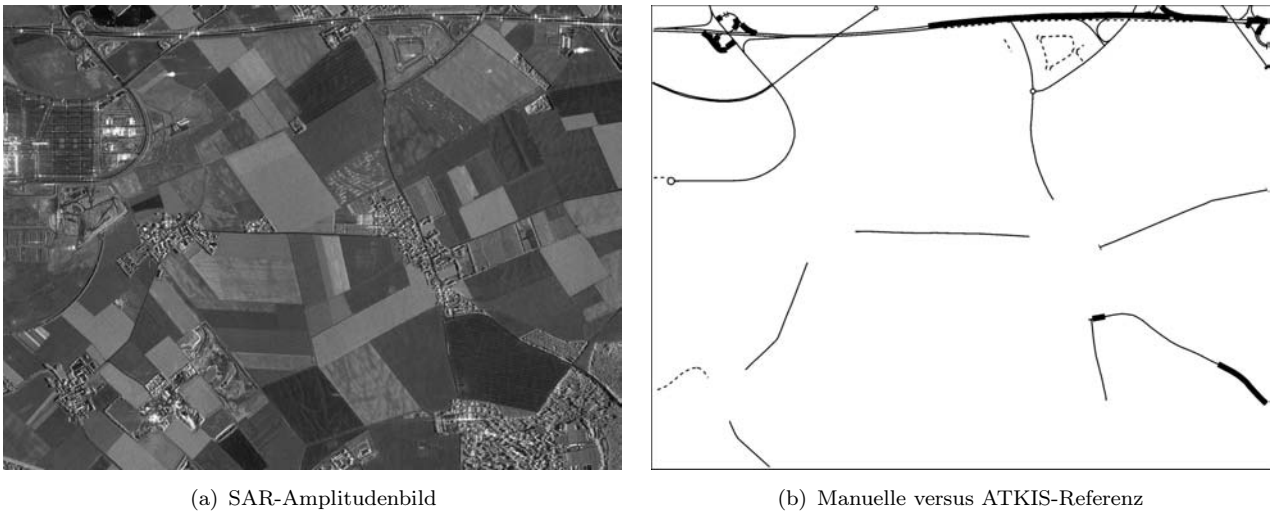
Abbildung 4.25. Datensatz Stadtrand-1m : Vergleich der manuellen Referenz gegenüber ATKIS-Daten (schwarze, dünne Linie: Übereinstimmung; schwarze, dicke Linie: keine Übereinstimmung bedingt durch Lagefehler; schwarze, gestrichelte Linie: nur in ATKIS-Daten vorhanden)
