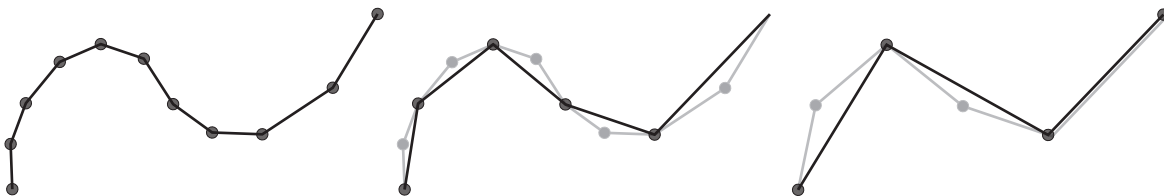
Abbildung 3.30: Reduktion des Polygonzuges in zwei Schritten von links nach rechts
