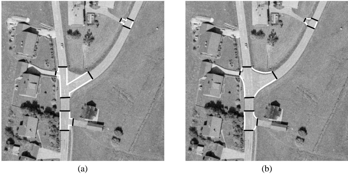
**Abbildung 5.24.** (a) Näherungen für Kreuzungen und Einmündungen (schwarz: feste Segmente, weiß: flexible Segmente) (b) Ergebnis der Snake-basierten Bestimmung der Kreuzungsbereiche
