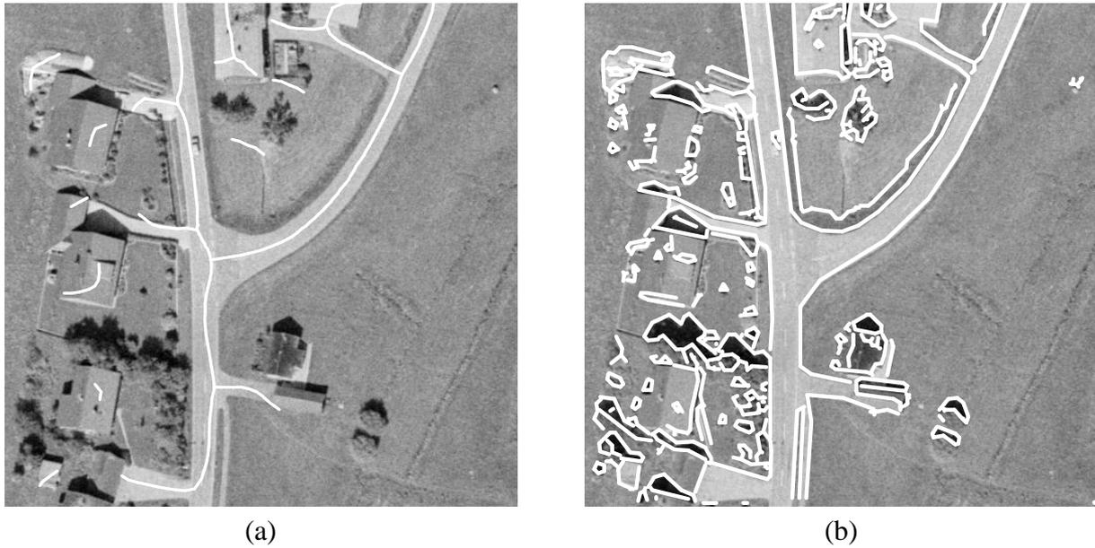
Abbildung 5.4. (a) Linien aus reduzierter Auflösung (b) Kanten aus hoher Auflösung
