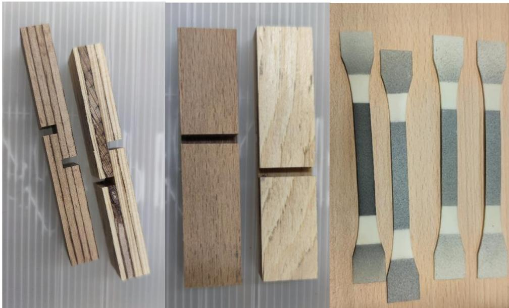
Abbildung 2. Probekörper aus Holzwerkstoffplatten (links: Seitenansicht, mittig: Aufsicht) sowie rechts: Schulterstabproben für die Zugscherversuche
