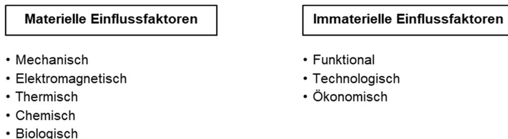
Abbildung 6: Einflussfaktoren Dauerhaftigkeit nach ISO 15686-1:2011-05
