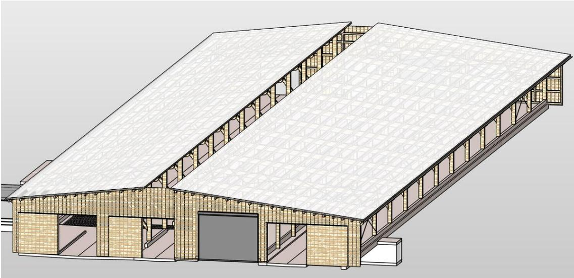
Abbildung 2: 3D-Ansicht des repräsentativen landwirtschaftlichen Gebäudes mit kleiner Spannweite bestehend aus 2-Reiher Liegehalle + 1 Reiher Liegehalle mit integriertem Futtertisch und Pultdachhalle (Spannweiten: 22,6 Meter (Spannweiten: 6,6 Meter (2-Reiher) + 5,20 und 6,20 Meter (1-Reiher))
