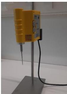
Abbildung 3. Sonifikator, zur Auflösung des Biofilmmaterials in Suspension.
