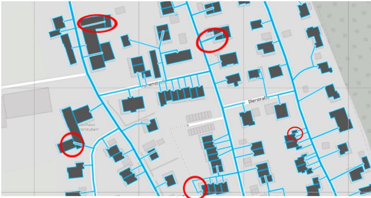
Abbildung 15: Beispiele fehlerhafter Netzauslegung (zu lang, unbeheizte Nebengebäude/Garagen, fraglicher Anschlusspunkt)
