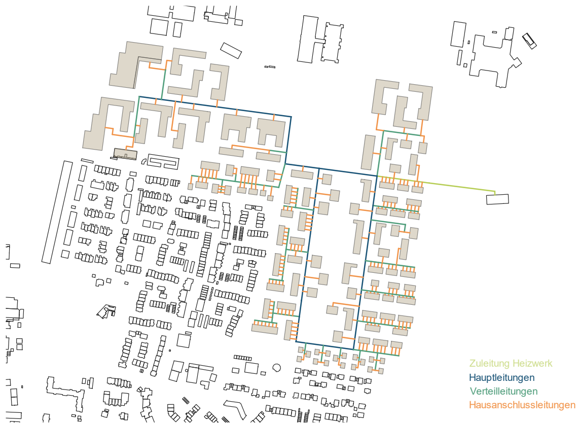
Abbildung 72: Händische gezeichnete Option eines Fernwärmenetzes für die Kommunikationszone mit grober Unterscheidung der Rohrleitungstypen
