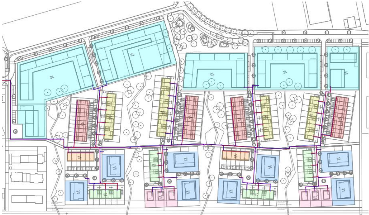
Abbildung 69: Entwurfsplanung Fernwärmenetz WaK, optimierte Erschließung (EST)
