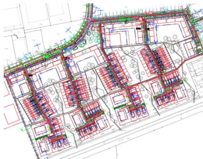
Abbildung 58: Entwurfsplanung Fernwärmenetz WaK klassischer Erschließung (EWG)
