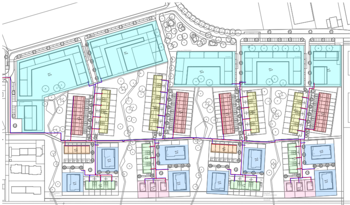
Abbildung 59: Entwurfsplanung Fernwärmenetz WaK, optimierte Erschließung (EST)
