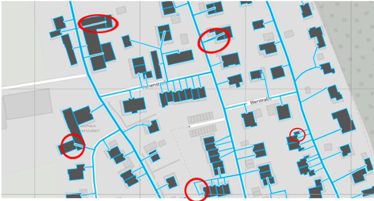
Abbildung 15: Beispiele fehlerhafter Netzauslegung (zu lang, unbeheizte Nebengebäude/Garagen, fraglicher Anschlusspunkt)
