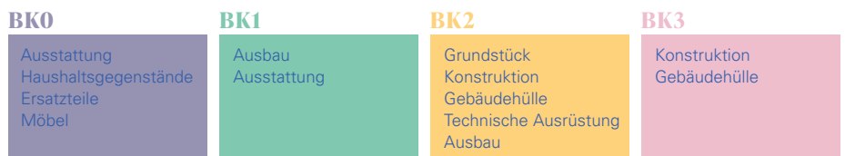
Abbildung 25 Zuordnung der Gebäudeschichten in die Bauproduktkategorien
