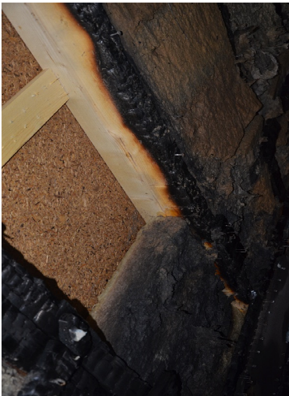
Abb. 18: Schutzwirkung der Steinwolldämmung für die Gefache, V2 aus TIMpuls
