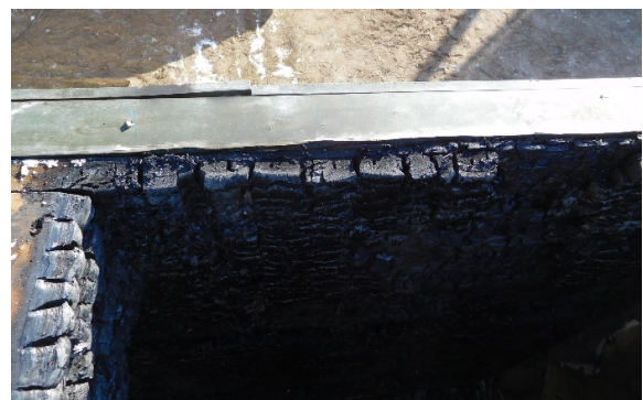
Abb. 21: Bauteilanschluss Decke-Wand 3, V4 aus TIMpuls
