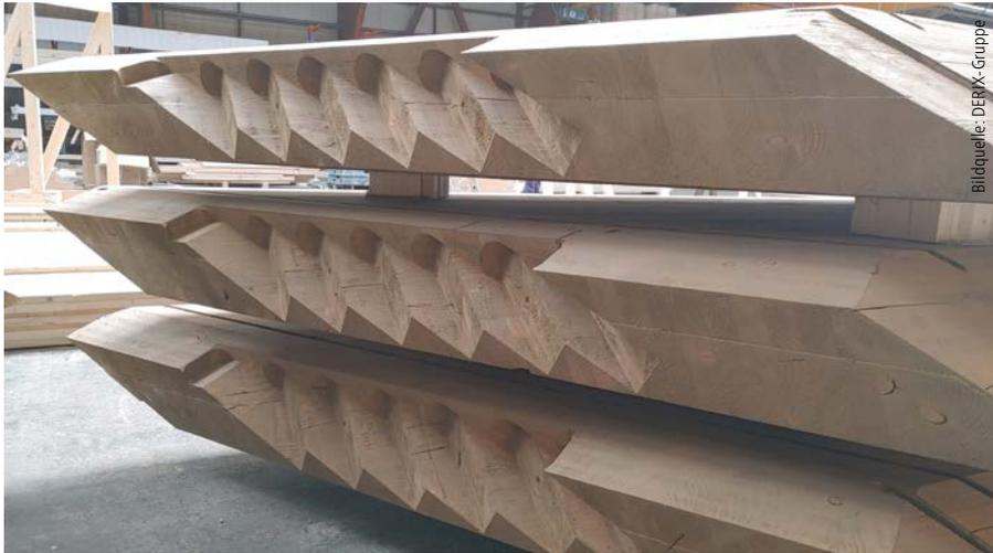
*Die hohe Präzision der computergesteuerten Vorfertigung bietet die optimale Voraussetzung für komplexe Geometrien.*
