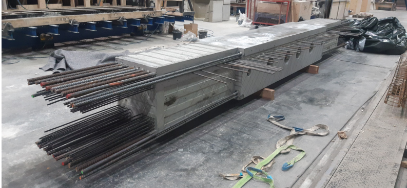
Abb. 8: Koppelriegel im Fertigteilwerk (Bild Fa. Rekers, Spelle)
