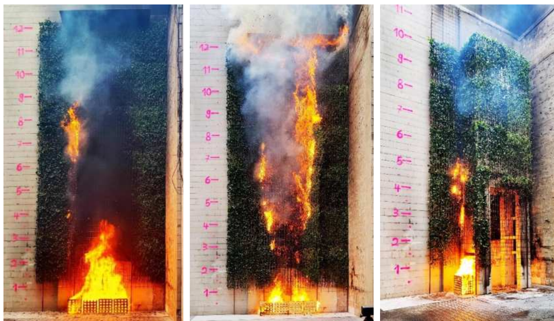
Bild 9: Links: Flächiger Versuch mit vitaler Begrünung (V1); Mitte: Flächiger Versuch mit getrockneter (toter) Begrünung (V2); Rechts: Balkonversuch mit Brandeinwirkung in der Ecke mit vitaler Begrünung (V4)
