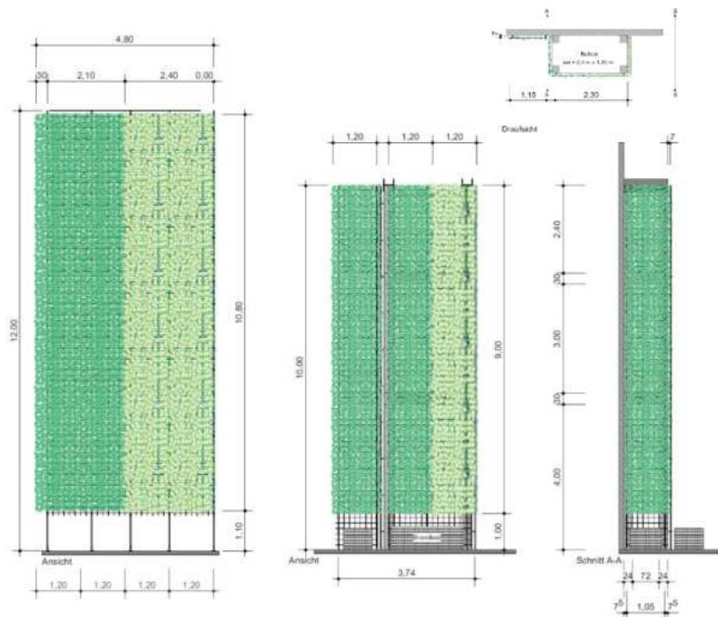
Bild 8: Links: Flächige Versuchsanordnung (12 m hoch) für die Versuche V0, V1 und V2; rechts: Balkonkonstruktion (10 m hoch) für die Versuche V3, V4, V5, V6 und V7 [16]
