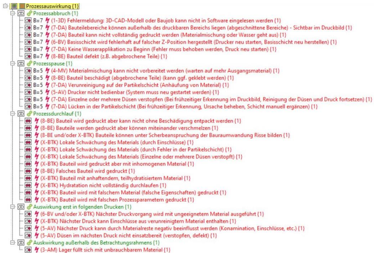
HB – Abbildung 16: Systemelement ‚Prozessauswirkung‘ mit Fehlfunktionen (Beispiel: SCA)
