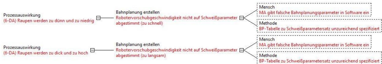
Abbildung 76: Auszug aus den Fehlernetzen zum Arbeitssystem: Bahnplanung erstellen
