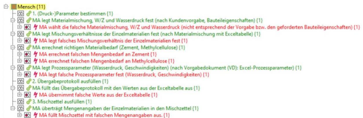
HB – Abbildung 13: Systemelement ‚Mensch‘ mit Funktionen und Fehlfunktion (Beispiel: SCA)
