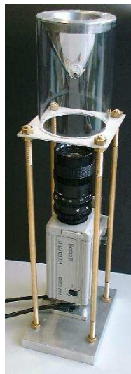
Abbildung 1.1: Omnidirektionales Sichtsystem mit hyperbolischem Spiegel
