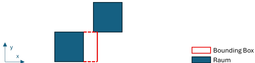
Abbildung 6.10: Grenzfall: Räume werden noch als Nachbarn erkannt, obwohl sie sich nur in einem Punkt überlappen
