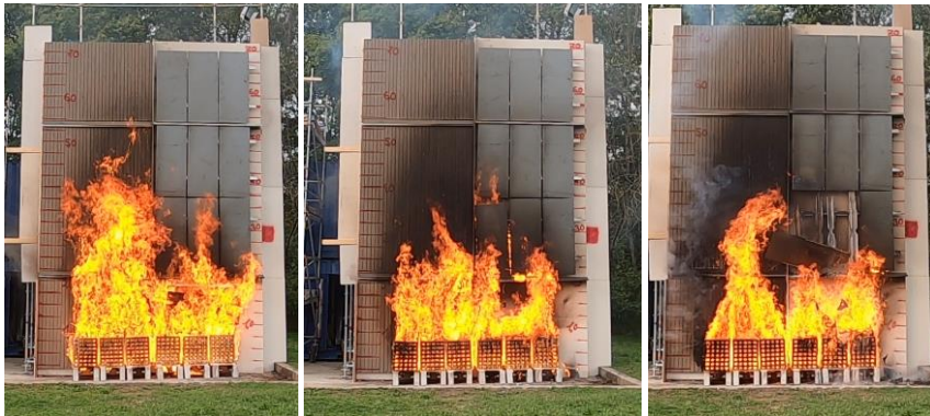
Abbildung 142: Abfallen der Module Modul 10 (links), Modul 7 (Mitte), Modul 8 (rechts) ■
