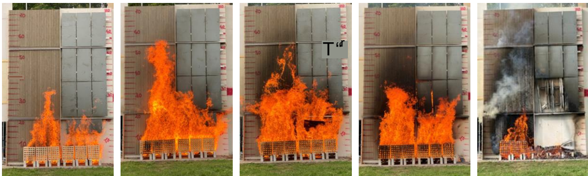
Abbildung 138: Prüfkörper während des Brandversuches (von links nach rechts: Minute 2, 3, 4, 10, 17) ■
