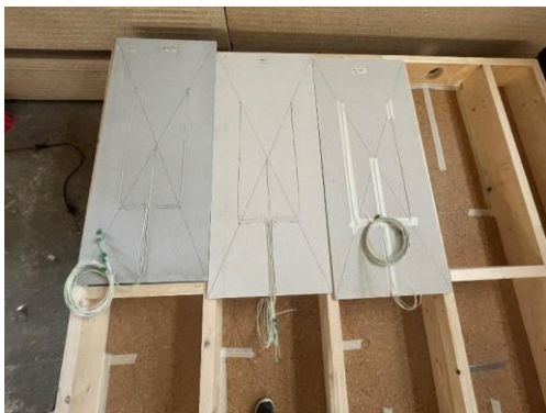
c) Führung der Thermolemente je Gefach
