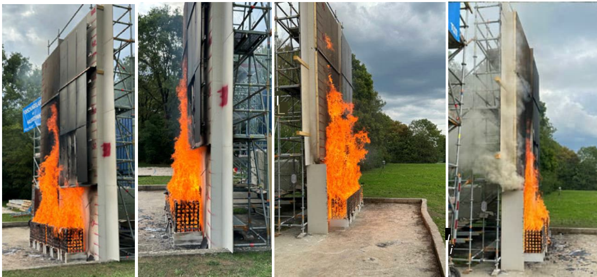
Abbildung 144: Brandeinwirkung auf das PV-Modul in der Primärflamme
