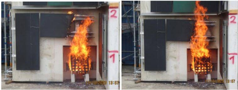
Abbildung 132: Brandeinwirkung auf das PV-Modul in der Stützflamme, Brand in der Zwischenschicht (links) und über die Brandsperre (rechts) ■
