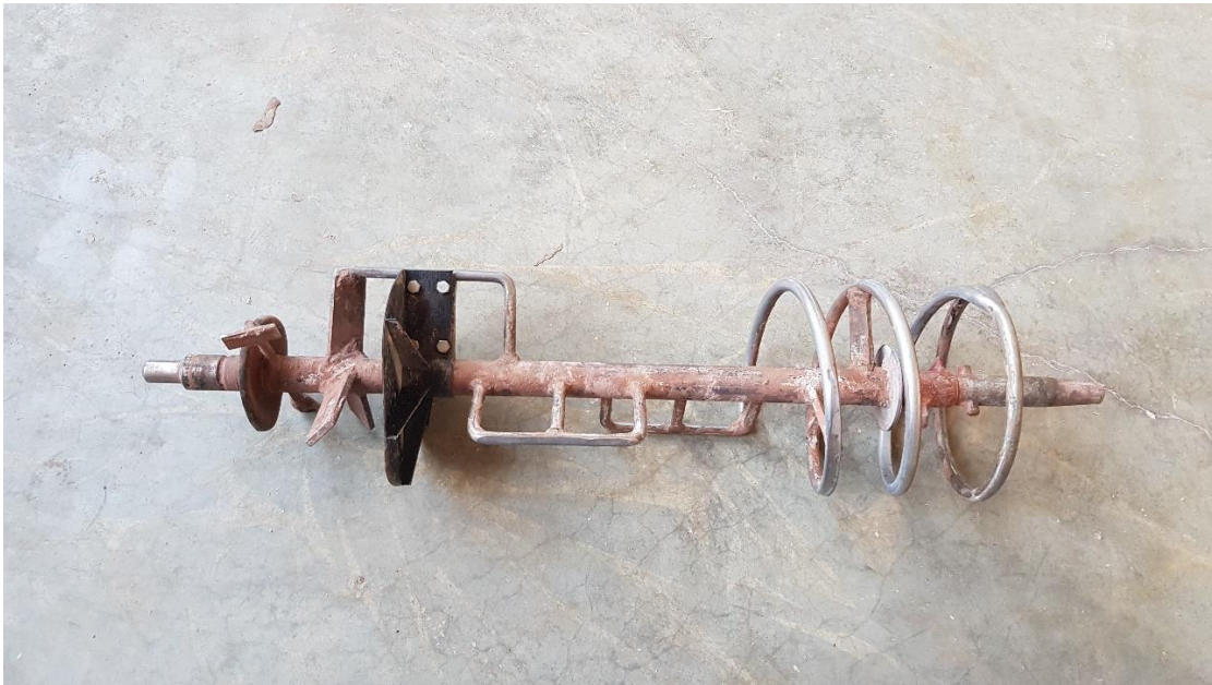
Abbildung 3-4 Mischwelle mit aufgeklemmter Stauscheibe
