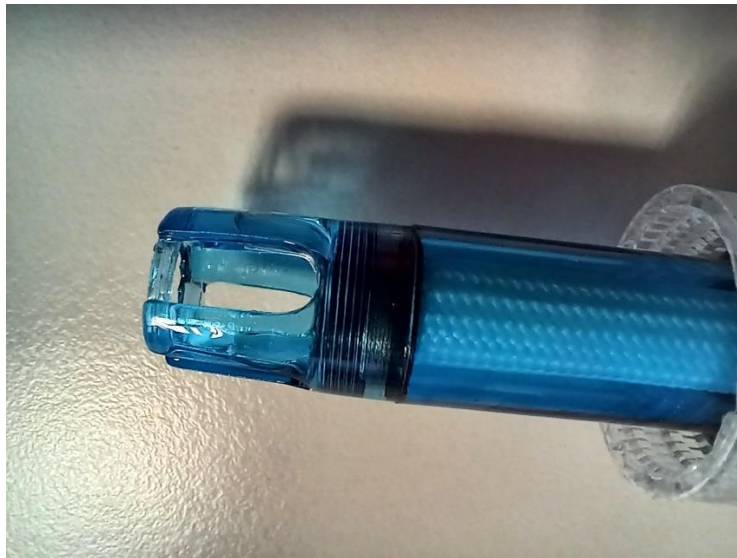
Abbildung 4-1 Bild einer Sonde zur Leitwertmessung Quelle: PHYWE, E. Tellbach
