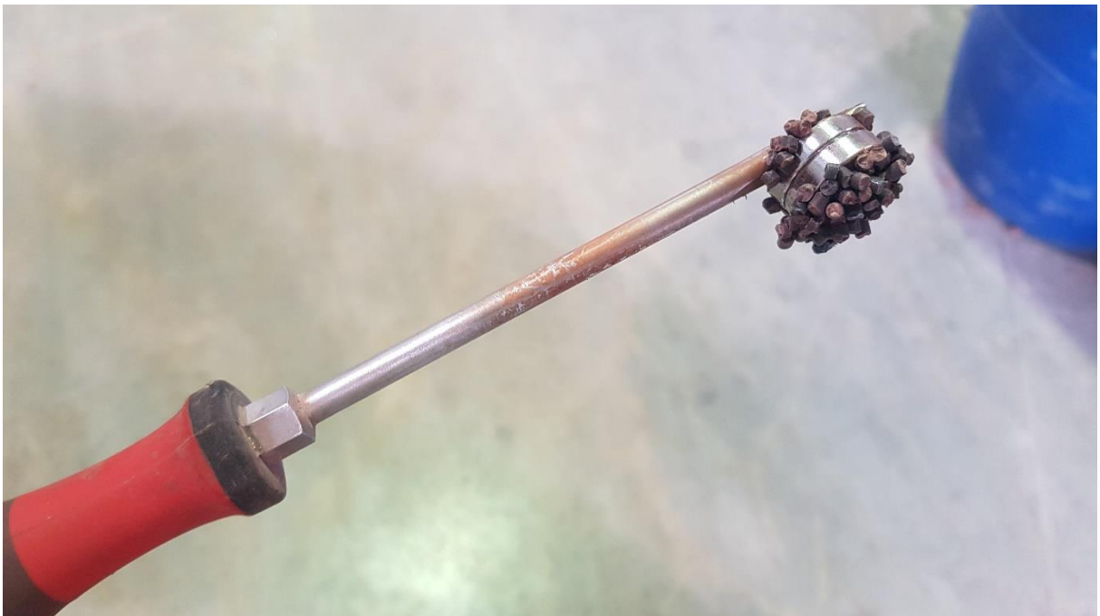
Abbildung 4-13 Ausgefischte Tracerpartikel am Magneten
