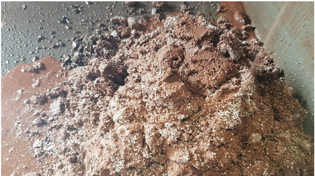
Abbildung 4-21 Mörtel aus dem Mischbereich mit dem in Tabelle 4-1 beschriebenen Parametersatz Nr. 4. Deutlich zu erkennen an dem noch Weißen Poraver ist die zu geringe Mischenergie.
