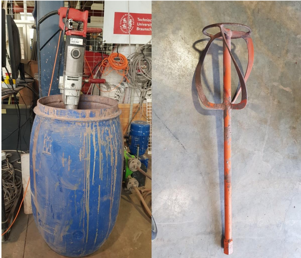
Abbildung 3-2 Links: Leimfass mit PFT Mixer Rechts: Wendelrührer
