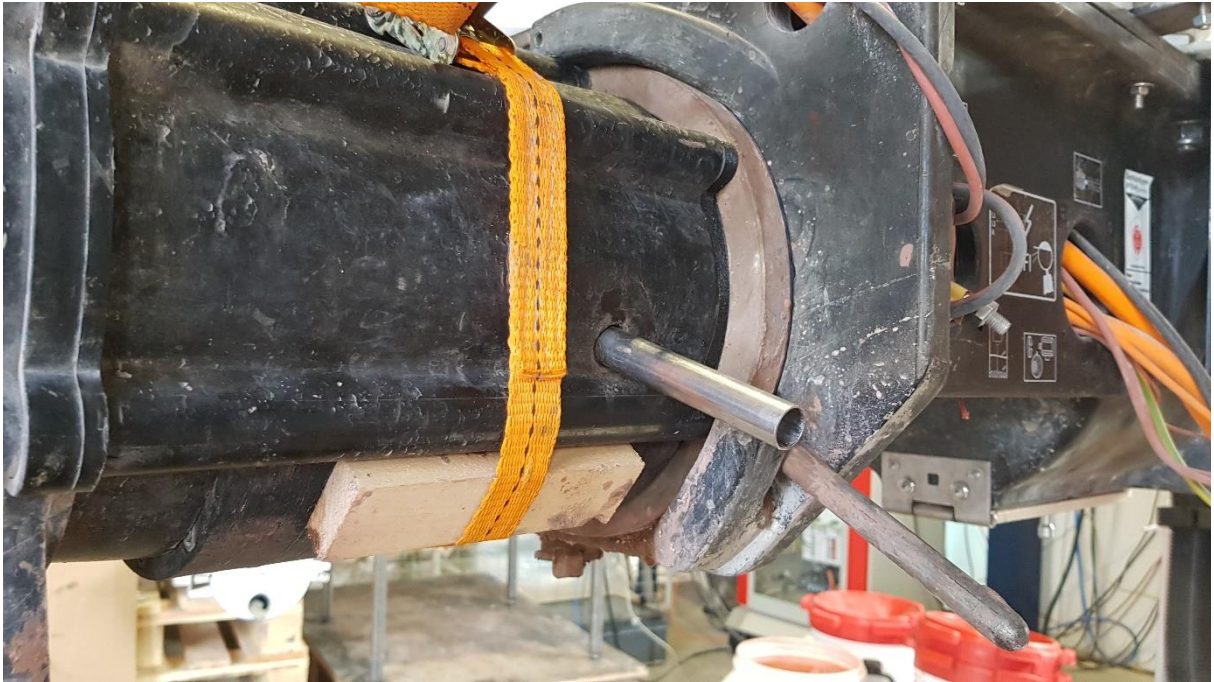
Abbildung 4-7 Kurzer Mischbereich mit Rohr für Tracerzuführung
