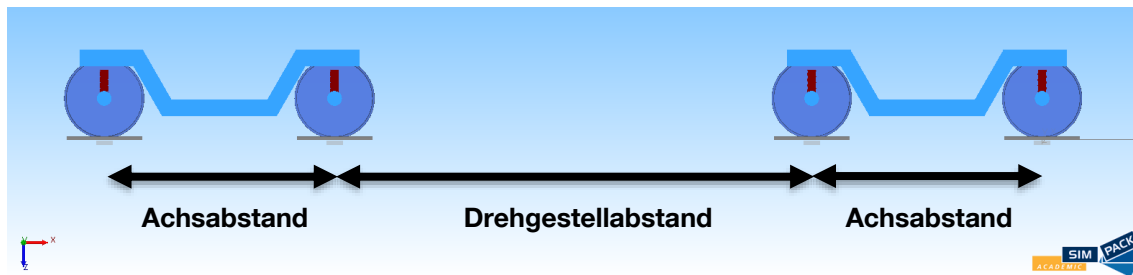
Abbildung 5-22: Illustration der Achsfolge des MKS Modells zur Bestimmung von Achslagerbeschleunigungen
