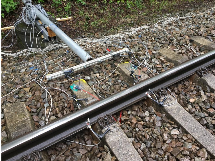
Abbildung 3-11: Messung von Vertikalverformungen mit induktiven Wegaufnehmern
