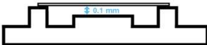
Abbildung 7: Schematische Darstellung einer Neubauer-Zählkammer (Seitansicht). Beide Zählraster haben eine Tiefe von 0,1 mm. Daraus resultiert ein Volumen von 0,9 mm 3 je Zählraster. Quelle: http://e-learning.studmed.unibe.ch/hemosurf_demo/Demo_D/Lab/count_manual.htm
