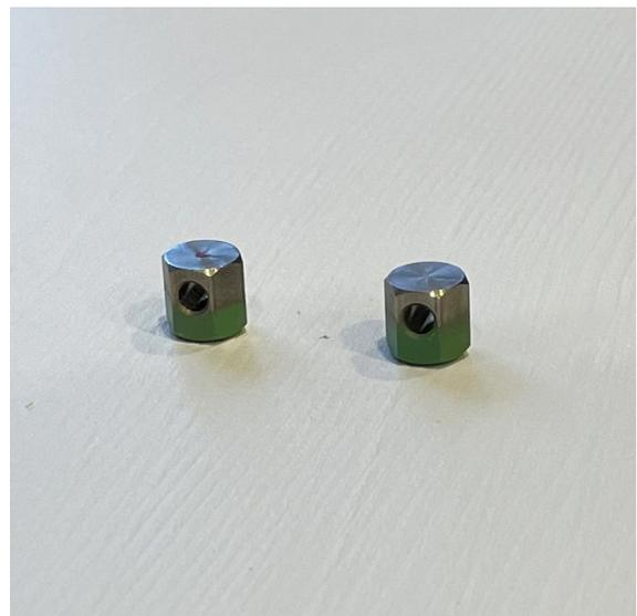
Abbildung 3-3: Einschlagelektroden der elektrischen Widerstandsmessung (Osman Kocan, 2024)
