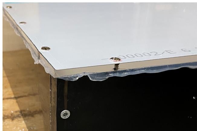
Abbildung 3-8: Mit additionsvernetzendem und unter Anpressdruck ausgebildete Fugen (Osman Kocan, 2024)
