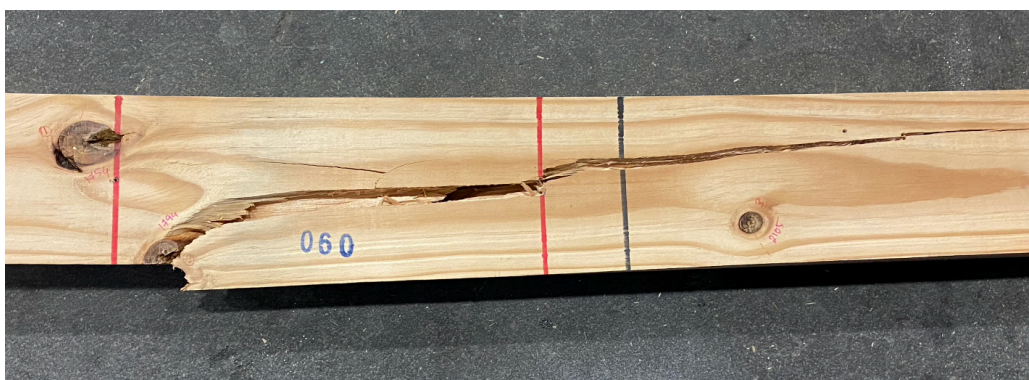
Abbildung 4-6: Bruchbild eines Langfaserbruchs mit Ast im Rahmen der Biegeprüfung, Vollholzprobe
