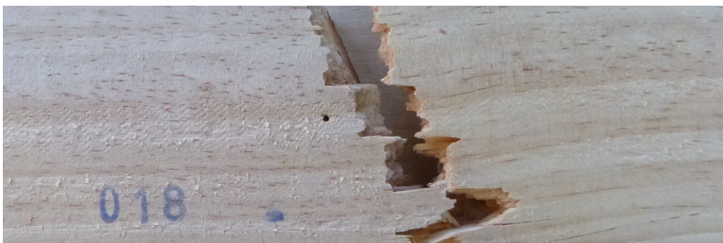
Abbildung 4-3: Bruchbild eines Kurzfaserbruchs ohne Ast im Rahmen der Zugprüfung, Vollholzprobe
