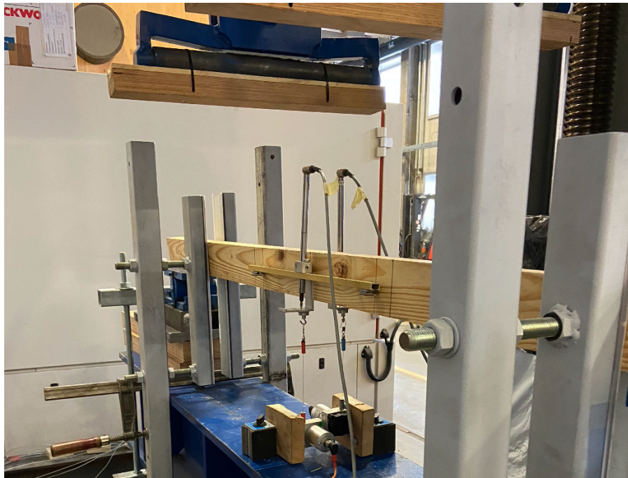
Abbildung 3-8: Prüfanordnung der Biegeprüfung am Lehrstuhl für Baukonstruktion und Holzbau der TUM
