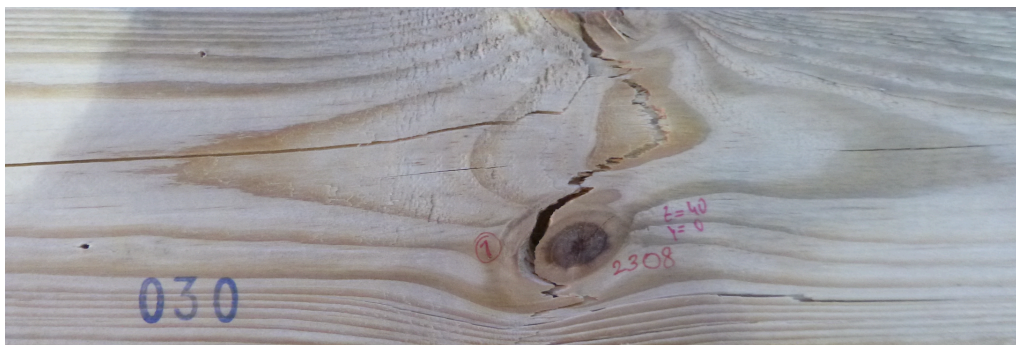
Abbildung A-2: Bruchbild eines Kurzfaserbruchs aufgrund eines Wipfelbruchs im Rahmen der Zugprüfung, Vollholzprobe
