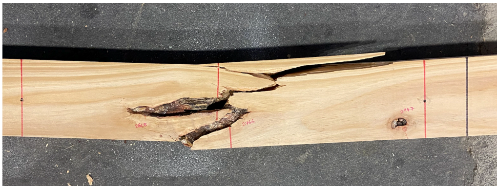
Abbildung B-1: Bruchbild eines Kurzfaserbruchs aufgrund von Rindeneinwuchs im Rahmen der Biegeprüfung, Vollholzprobe
