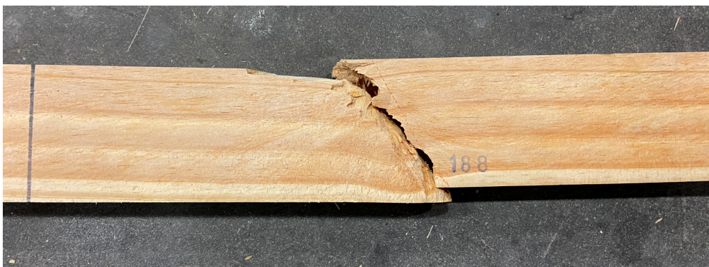
Abbildung B-2: Bruchbild eines Kurzfaserbruchs ohne Ast im Rahmen der Biegeprüfung, Vollholzprobe
