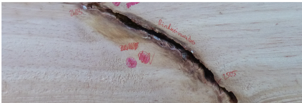
Abbildung A-1: Bruchbild eines Kurzfaserbruchs aufgrund von Rindeneinwuchs im Rahmen der Zugprüfung, Vollholzprobe
