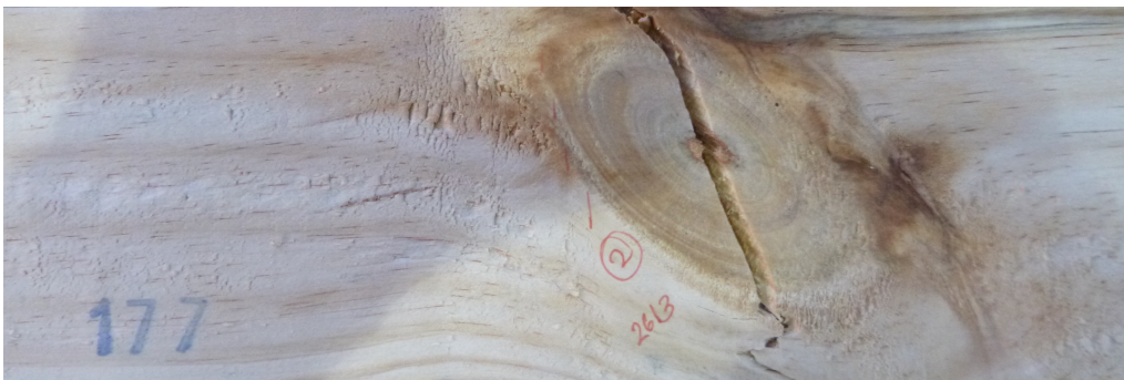
Abbildung 4-2: Bruchbild eines Kurzfaserbruchs mit Ast im Rahmen der Zugprüfung, Vollholzprobe
