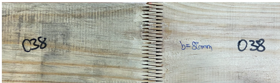
Abbildung 4-8: Bruchbild eines reinen Scherbruchs, Keilzinkenprobe
