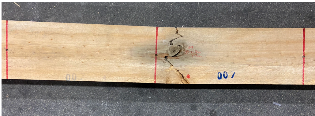
Abbildung 4-5: Bruchbild eines Kurzfaserbruchs mit Ast im Rahmen der Biegeprüfung, Vollholzprobe
