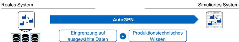
**Abbildung 4.2:** AutoGPN kombiniert spezielle Daten aus der Auftragsabwicklung mit produktionstechnischem Wissen, um ein ausführbares Simulationsmodell des realen Systems zu erzeugen.
