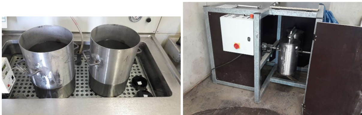
Abbildung 3-11: Prüfung des Schüttel-Abriebverfahrens am Marshall-Probekörper [32]
