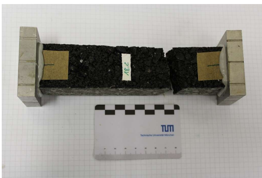
Abbildung 11-3: Probekörper der Probe D-18.2 nach erfolgter Zugprüfung
