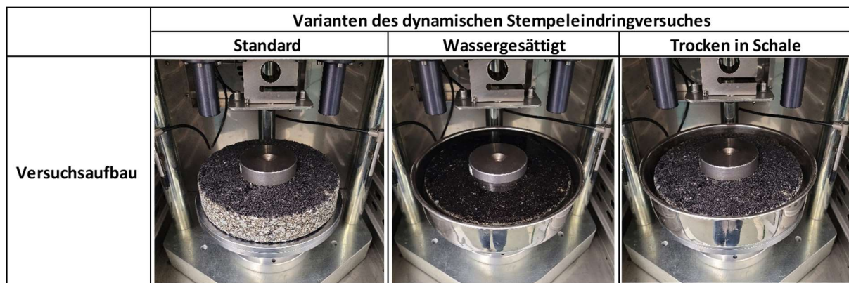
Abbildung 9-4: Varianten des Stempelleindringversuches zur Prüfung der Wasserempfindlichkeit von feinen Gesteinskörnungen
