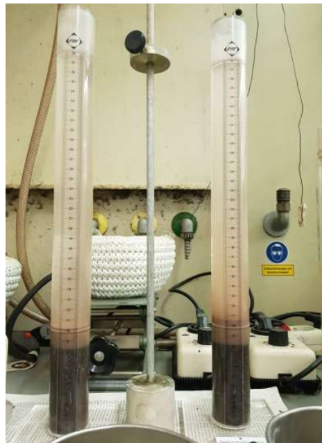
Abbildung 3-8: Sandäquivalentverfahren nach EN 933-8 [35]
