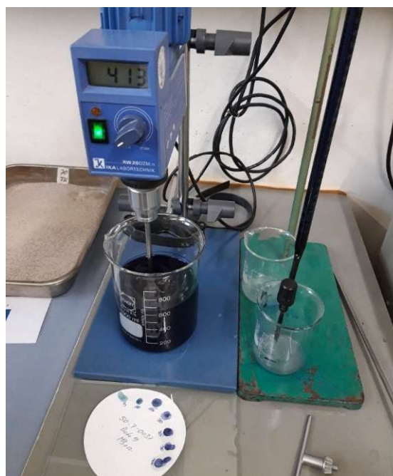
Abbildung 3-7: Versuchsaufbau zur Bestimmung des MB-Wertes [8]
