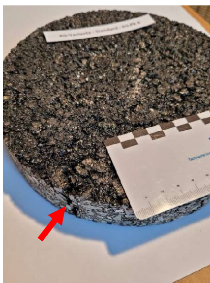
Abbildung 9-5: Fotodokumentation der ersten Anzeichen des Versagens des Probekörpers
