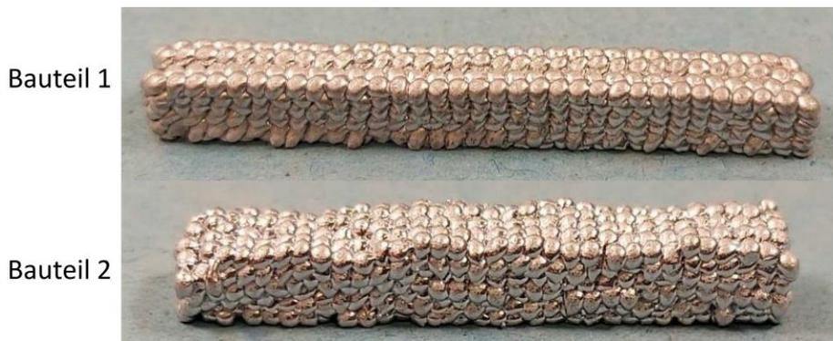
Abbildung 32: Gedruckte Quader aus Aluminium zur Vermessung: Bauteil 1 (oben) besitzt eine gleichmäßige Oberfläche, während die Oberfläche von Bauteil 2 (unten) sichtbare Unebenheiten aufweist.
