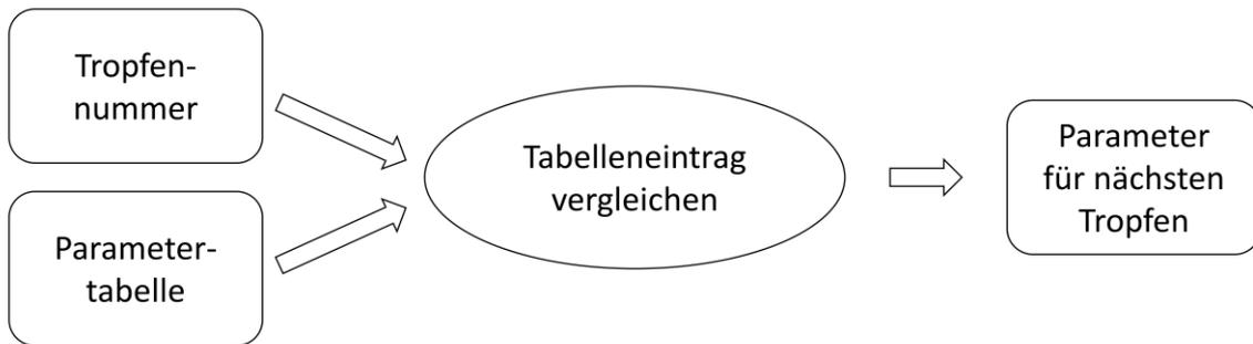
Abbildung 7: Prozess zur individuellen Parameteranpassung für jeden Tropfen; sofern in der Parametertabelle kein individueller Eintrag vorliegt, werden die Standardeinstellungen verwendet.
