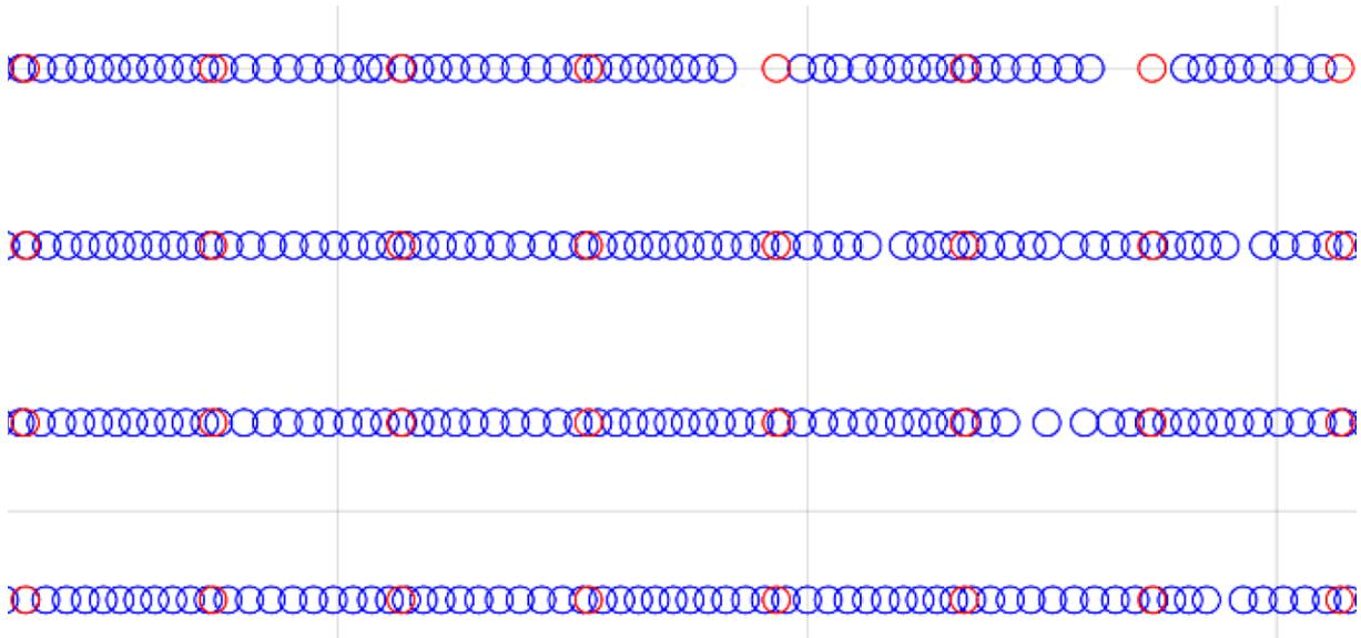
Abbildung 24: Draufsicht auf die Rohdaten (blau) und die vorverarbeiteten Daten (rot); durch die Reduktion und Interpolation der Datenpunkte wird ein einheitliches Raster für die Vernetzung generiert.
