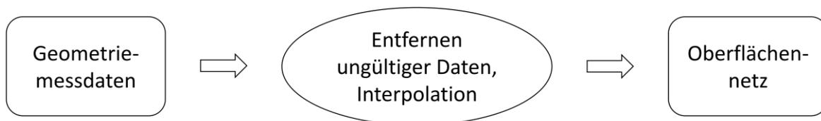
Abbildung 5: Vorgehen zur Auswertung der gewonnenen Messdaten einer gedruckten Bauteilschicht: Aus den Messdaten werden ungültige Messergebnisse entfernt. Die verbliebenen Messdaten werden durch Interpolation in ein gleichmäßiges Raster überführt und durch Vernetzung die Bauteiloberfläche rekonstruiert.
