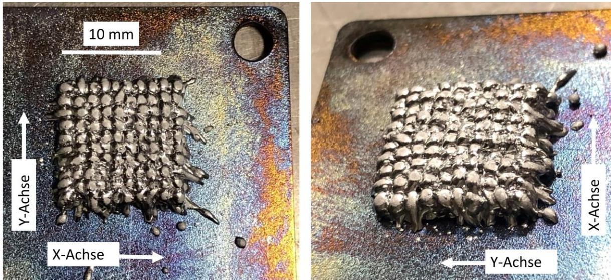
Abbildung 38: Gedruckter Probekörper bestehend aus drei Schichten, aufgenommen aus zwei unterschiedlichen Ansichten; zu sehen ist die Tropfenmatrix bestehend aus 100 Tropfen je Schicht. Teilweise sind Satellitentropfen neben dem Bauteil auf der Druckplatte zu sehen.
