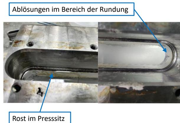
Abbildung 15: Schadensbild des konischen Presssitzes nach Überbelastung
