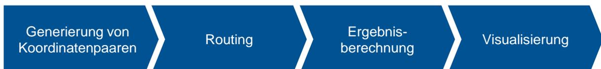
Abbildung 3.3: Schematische Darstellung des Ablaufs der Methodik zur Berechnung des Zusammenhangs zwischen Reisedistanz, Luftliniendistanz und Fahrzeit
