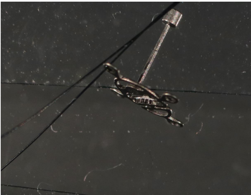
Abbildung 10: Ausgeklappte Spikes im 90°-Winkel. Variante 2 nach der Testung
