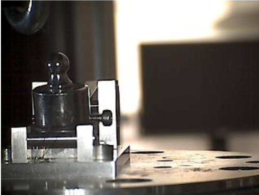
Abbildung 16: Prüfaufbau mit Spike-Implantat Variante 2, Perspektive von vorne, nach der Testung. Prothese wurde durch den Test weggezogen
