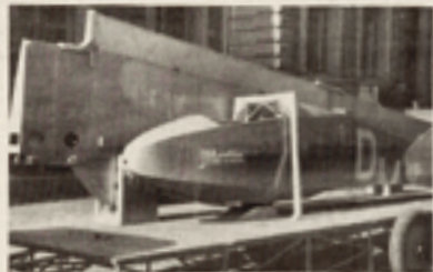
Die Tragfläche vormontiert
