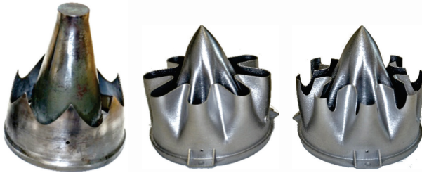
Abbildung 7.12: Chevrongüse CVN (links), blütenförmige Primärdüsen LMN (Mitte) und LMN-Sc (rechts)
