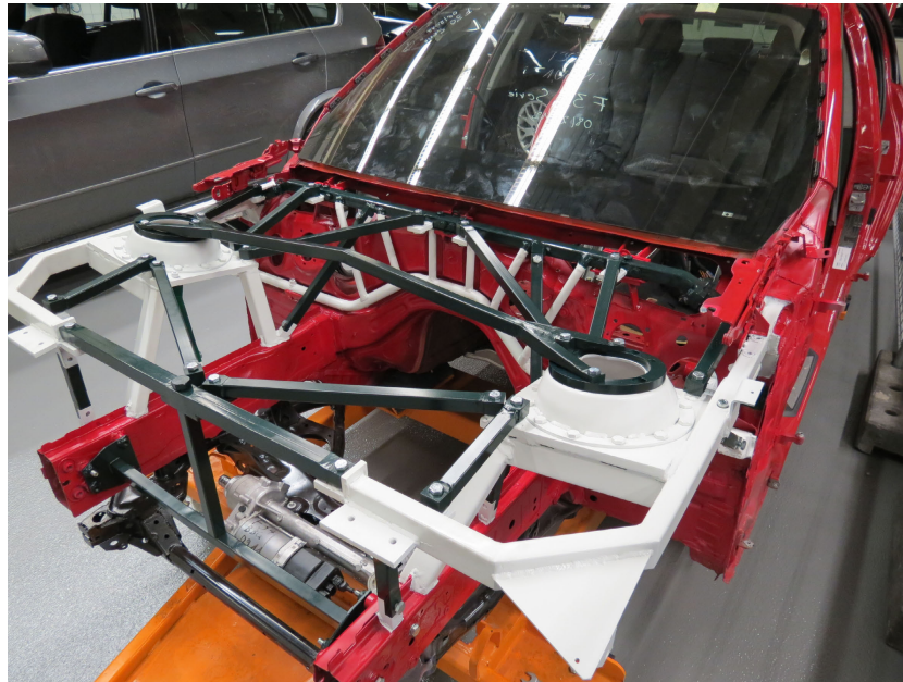
Abbildung A.3.: Versuchsfahrzeug abgerüstet: Originale Fahrzeugstruktur (rot), Grundstruktur (weiß), optionale Skalierungsmaßnahmen (grün)
