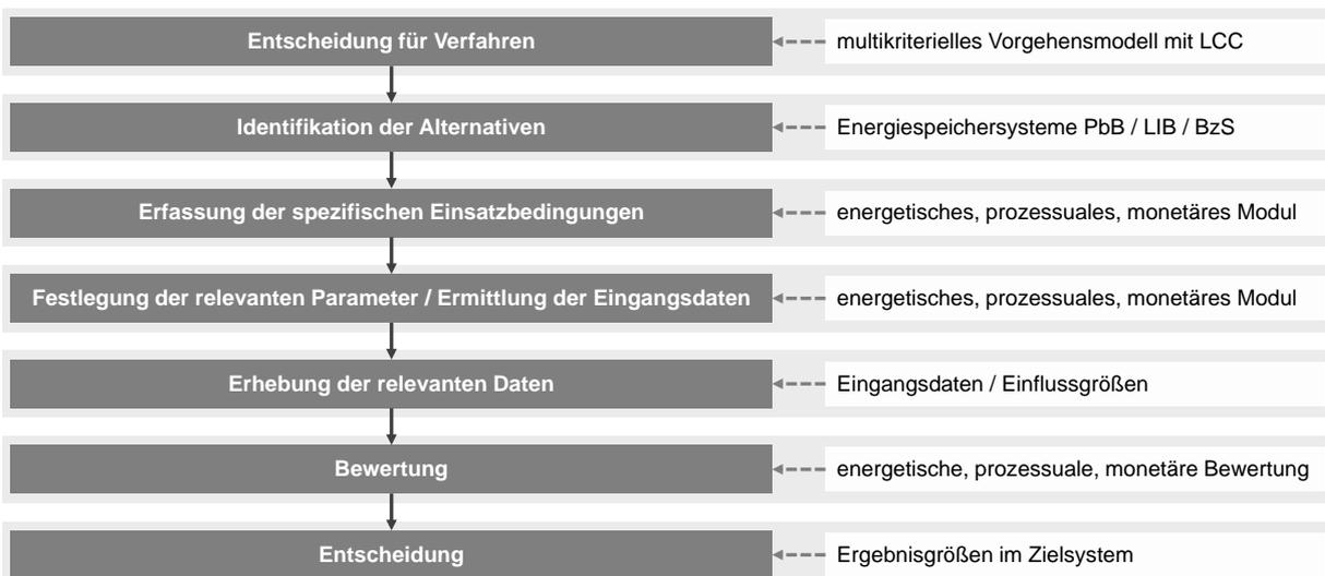
Abbildung 7-2: Vorgehensschritte bei Anwendung des Modells in Anlehnung an [VDI-2884]
